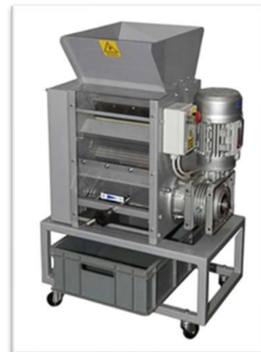
ROMPI GUSCIO per frutta secca, con rulli dentati SHELL BREAKING MACHINE for dried fruit, with toothed cylinders MACHINE À CASSER LES COQUILLES pour fruits secs, avec cylindres dentés
